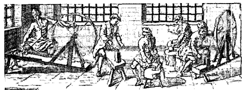
대차륜선반(大車輪旋盤): 18세기
