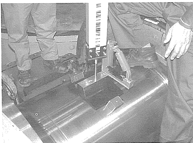
[그림 9] Digital Level Gauge로 Journal Level 측정현장
