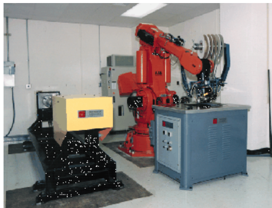
그림 4. NASA Langley 복합재료 센터의 열가소성 복합재료용 자동섬유적층장비
