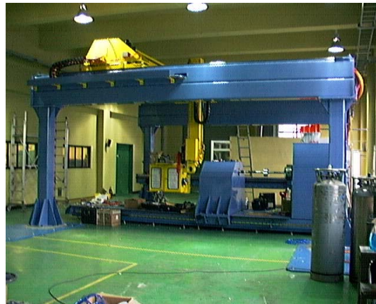
그림 1. 한국기계연구원에서 보유중인 7축 제어 자동섬유적층장비(FPS : Fiber Placement System)
