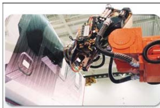
그림 2. 자동섬유적층장비를 이용하여 항공기 구조물을 제작하는 장면
