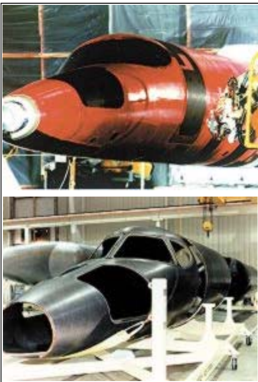
그림 3. Raytheon 항공사에서 Cincinnati Milacron의 자동섬유적층장비를 이용하여 제작한 항공기의 복합재료 fuselage
