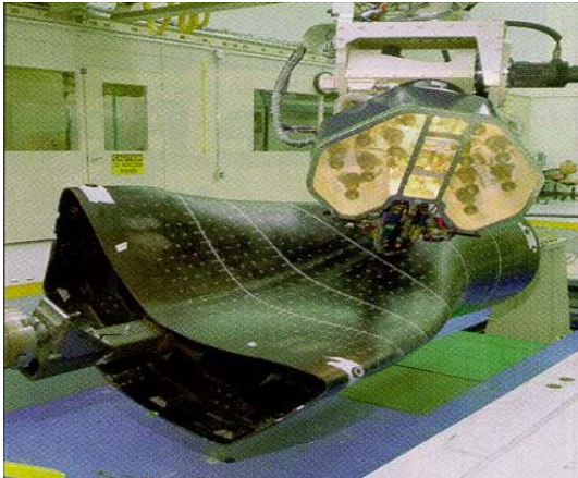
그림 16. Carbon/epoxy 프리프레그테이프를 이용하여 자동섬유적층장비로 제작한 Rolls-Royce 엔진용 복합재료 Bypass Duct
