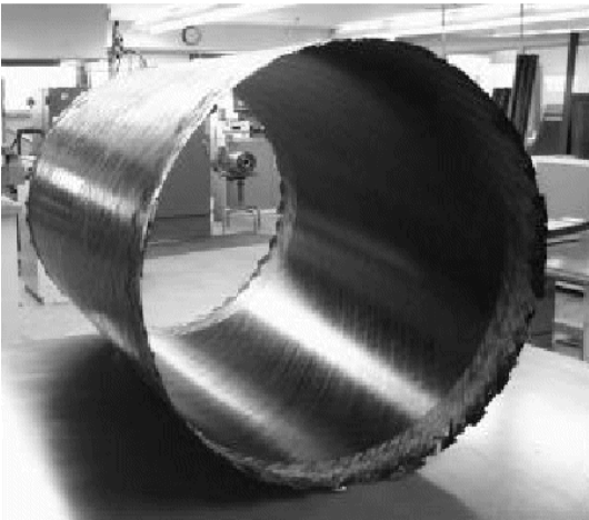
그림 5. CDDS를 위하여 자동섬유적층장비를 이용하여 제작된 열가소성 복합재료(APC-2) 실린더
