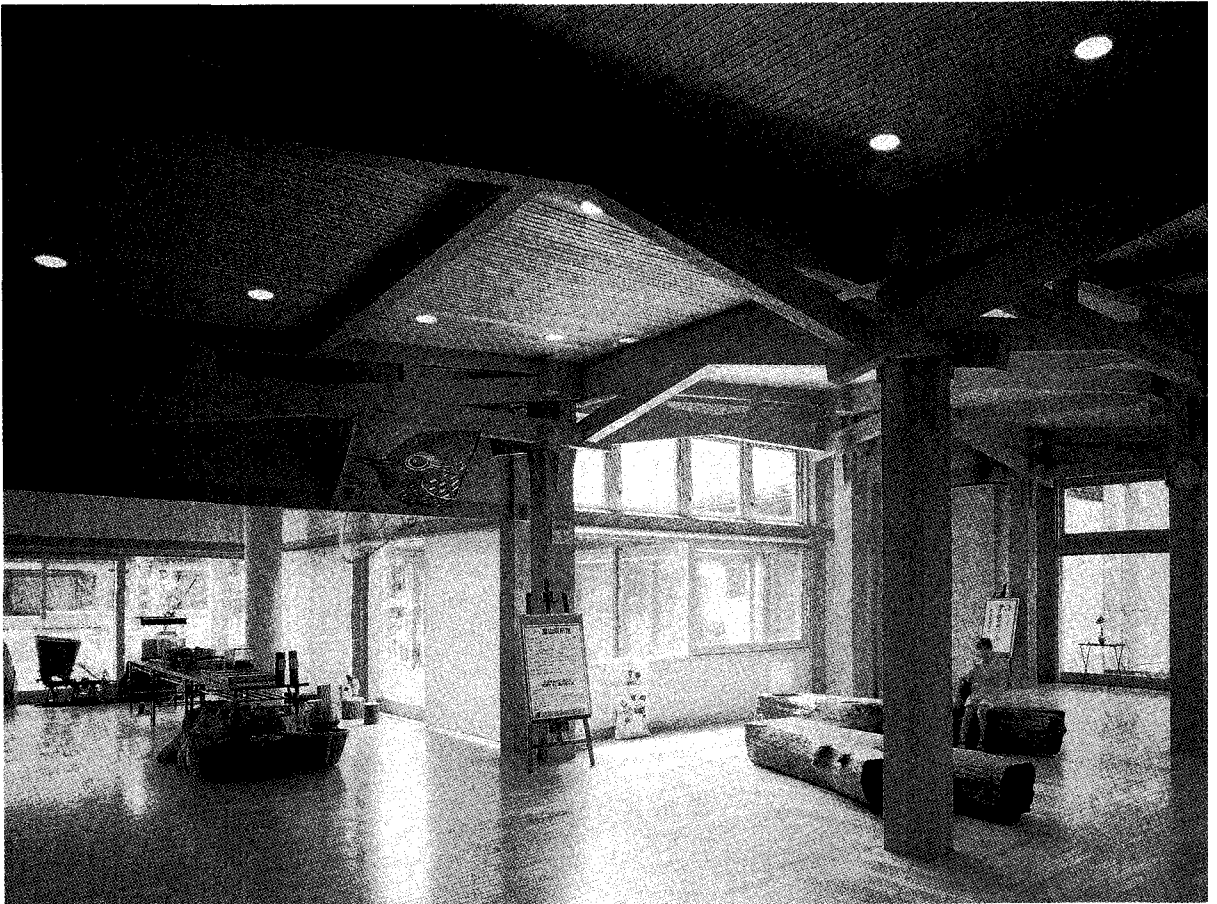
엔트런스홀. 대단면 집성재를 사용함으로써 목조로 대공간을 구성하였다. 기둥은 285mm각, 전통공법을 기본으로 하면서 4개의 보를 井자형보로 조립하여 상하 2단으로 하였다. 1개의 기둥에 8개의 보가 집합한다. 왼쪽 사진은 남쪽에서 본 외관. 풍차는 연못의 펌프 동력원이 되고 있다.
