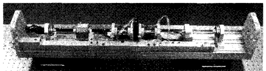
▲ Dual Module형 저차 모드 100W급 DPSSL 발전기 헤드부
