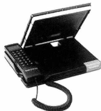
동서비스는 노트 PC나 PC에 장착 가능한 위성 모뎀을 이용하는 것으로, 위성 네트워크로부터 휴대 전화 네트워크로 전환하고 싶을 때는, 전화기로부터 가입자 특정용의 모듈 카드(SIM 카드)를 빼어 내, 모뎀에 접속한다. SIM 카드는 GSM 휴대전화로 사용되고 있는 IC카드로, GSM 캐리어에 접속하는데 필요한 가입자 정보가 보관되고 있다.
