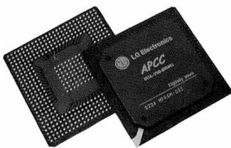
LG 전자가 비동기전송모드(ATM)방식의 차세대 이동통신 IMT-2000 기간 망 전송의 핵심기능을 담은 주문형반도체(ASIC)를 개발, 업계에서 처음으로 상용화에 성공했다.
