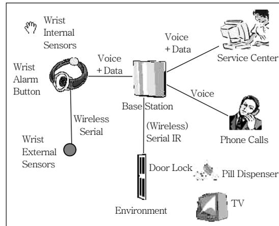
(그림 4) SILC 시스템 구성도
