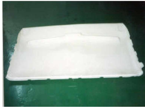
경량단열판재를 이용한 자동차용 Head Liner
