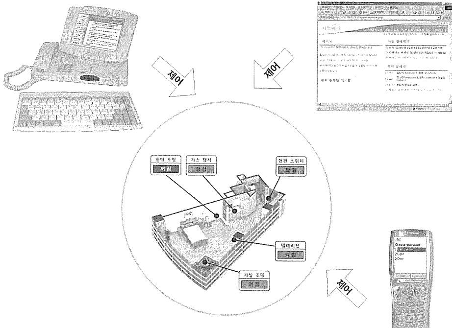
아르마리는 Thin Client 장비, PC(인터넷), 휴대폰으로 네트워크로 연결된 시스템을 통해서 원격지에서 가정내의 가전기기 제어 및 경보장치 감지가 가능하다. 또한 커뮤니티 시스템을 통해서 쇼핑, 공동구매, 친목 동호회 등을 구성하여 사람들간의 커뮤니티를 구성하며, 메시징 시스템을 통해서 이웃간에 쪽지를 주고 받을 수 있다. 또한 각종 지역사회 및 단지내 소식을 실시간으로 열람가능하다. 이는 기존의 단순한 홈오토메이션 기능을 넘어서 사이버 아파트 환경에 적합한 통합된 솔루션을 제공하고 있다.
