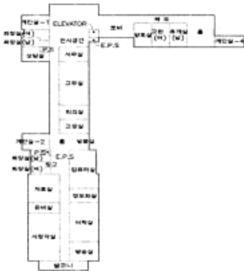
그림 4. 신축H초교 정보통신(EPS)공간 확보사례
