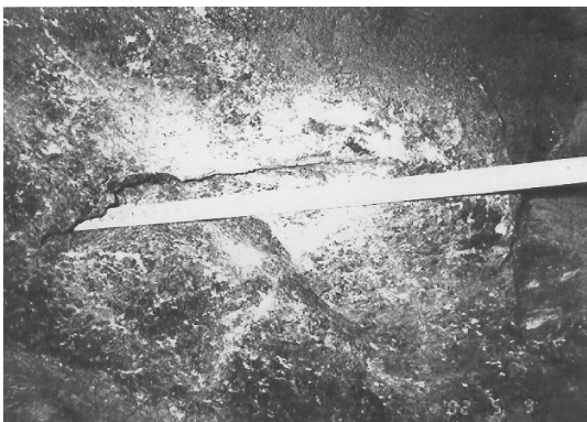
그림 5. V - Cut 발파공법 적용후 측정된 잔류공 깊이의 모습
