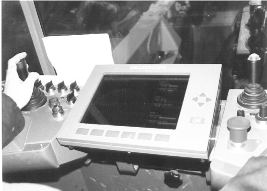
그림 8. Jumbo Drill 내부에 설치된 컴퓨터의 모습
