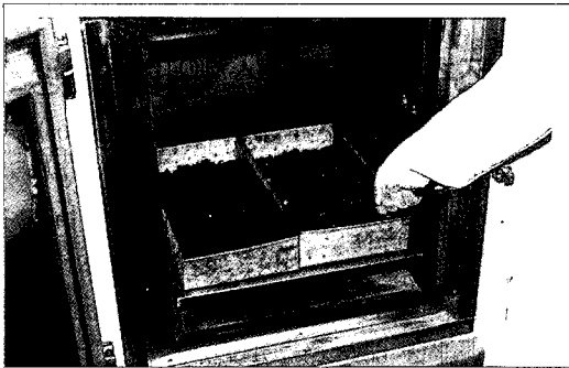
그림 3. Stirring of asphalt mixtures during SA.
