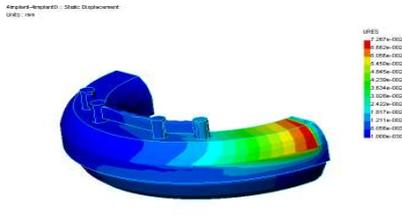
Fig. 47. OVD-4 (90°) : Displacement
