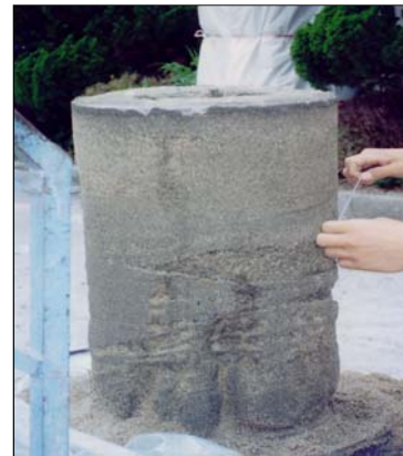
사진 4. 대형몰드에 MSG-N을 주입한 후 고결체
