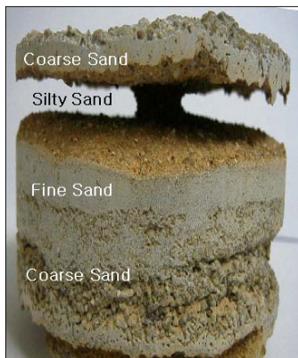
사진 3. 복합지층에 대한 MSG-N형 주입시편
