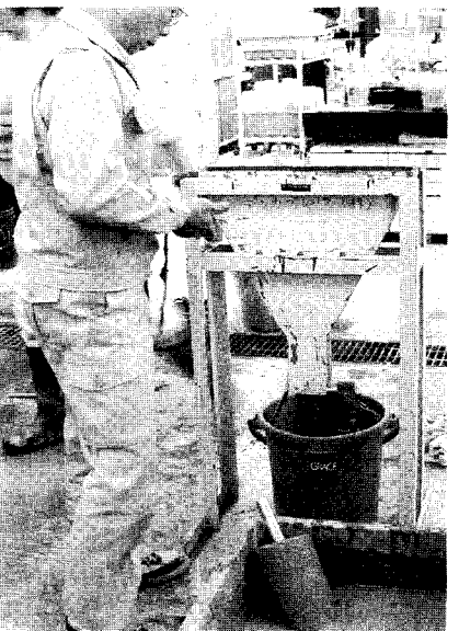
사진 3. V형 깔때기에 의한 유하 시험장면
