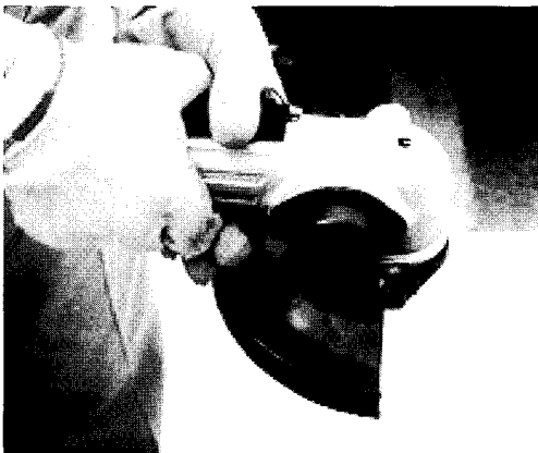
그림 5 가속도계 및 어댑터 핸들의 부착위치
