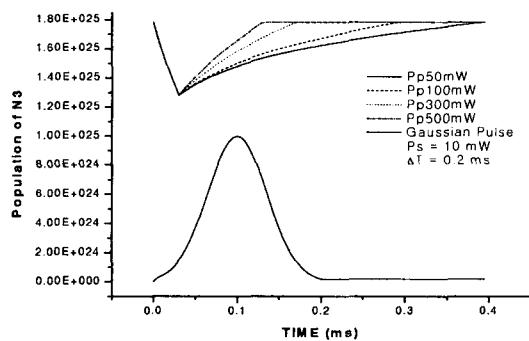
그림 2. single pulse의 펌프파워에 대한 N<sub>3</sub> 준위의 밀도변화
