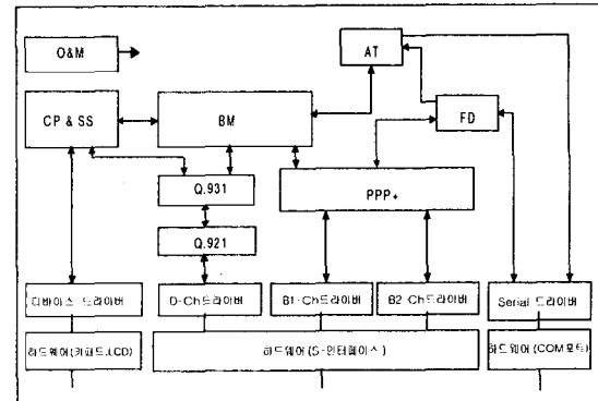
그림 6. ISDN 단말용 SW 블록도
