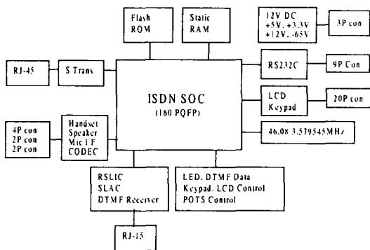
그림 10. ISDN 시스템-온-칩 활용 단말 구성도
