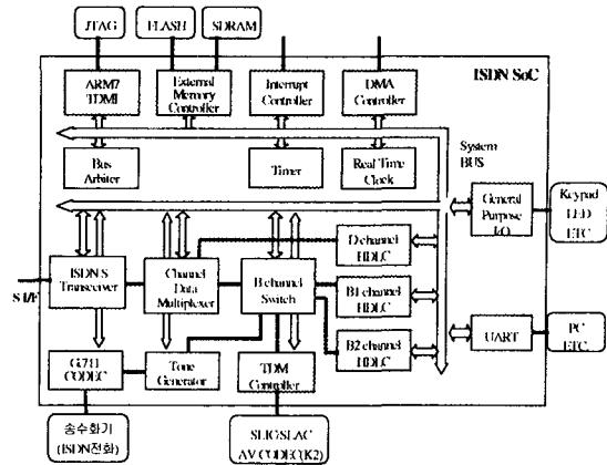
그림 1. ISDN 단말용 시스템-온-칩 전체 구성도
