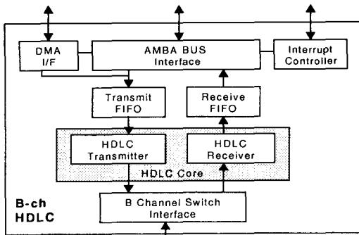
그림 5. B-채널 HDLC 블록도
