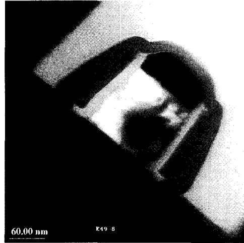
그림 2. 0.15 \mu\text{m} CMOS 기술을 이용하여 제작된 NMOS 소자 단면도 Fig. 2. Cross sectional profile of fabricated NMOSFET using 0.15 \mu\text{m} CMOS Technology.
