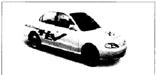
〈그림 17〉 무단변속기를 장착한 병렬형 하이브리드 승용차인 현대자동차의 이반테 하이브리드(1999년, 한국)
