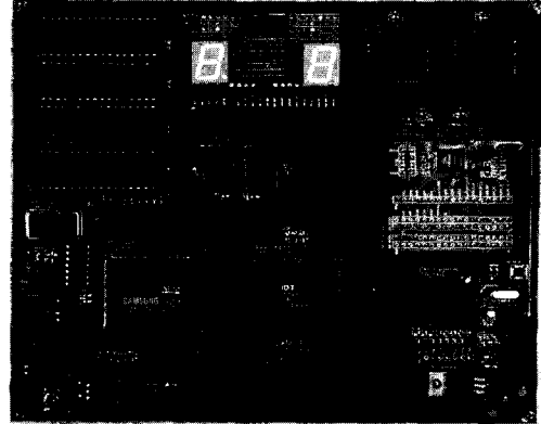
그림 8 Dual Port Memory를 이용한 통신 프로토타입 보드
