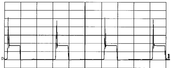
그림 6 스너버가 없는 경우 스위치 전압 파형 ( V_{ds}=50\text{V/div. time}=20\mu\text{s/div.} ) Fig. 6 Switch voltage waveform without snubber circuit ( V_{ds}=50\text{V/div. time}=20\mu\text{s/div.} )
