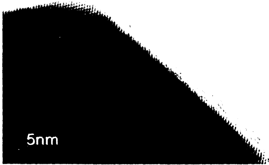
Fig. 7 초박막절편법에 의한 분말의 균일한 TiO 2 나노코팅층 두께 확인
