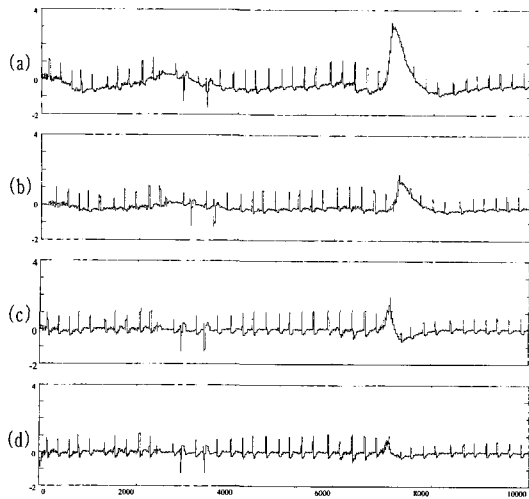
그림 8. MIT-BIH(210) 심전도 데이터를 필터링한 결과 (a) 원 신호 (b) 표준 필터 출력 (c) 적응 필터 출력 (d) RBF 신경망필터 출력
