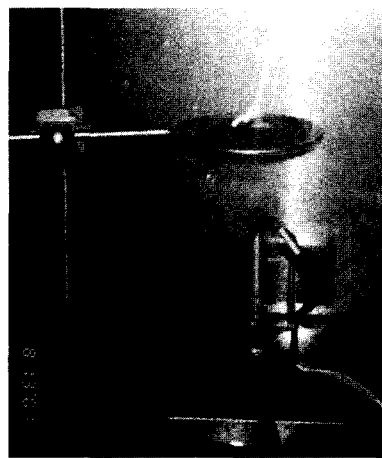
그림 7. 가스측정 장치 설치 및 시료의 연소 장면.
