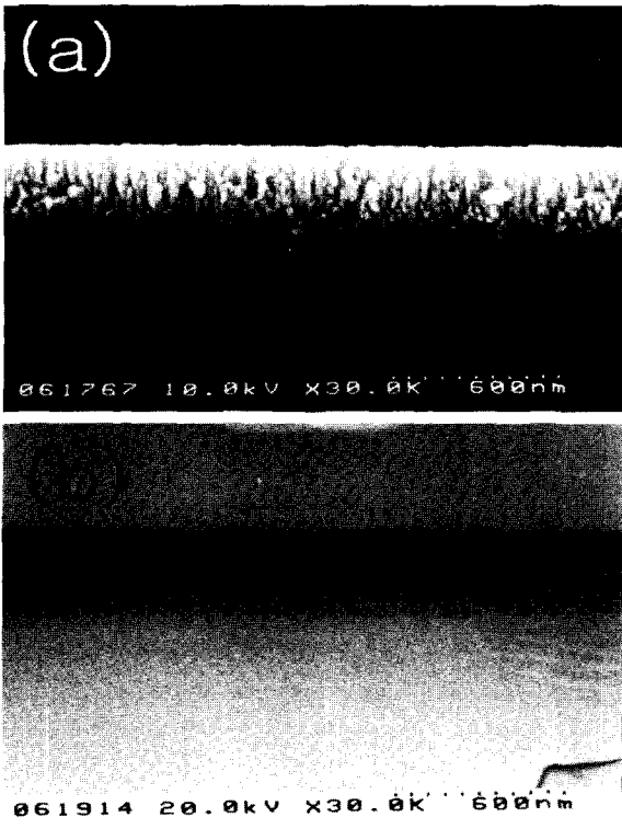
그림 6. Nb 2 O 5 박막의 단면 SEM 사진. (a) 보통 Nb 2 O 5 박막 (b) IBAD Nb 2 O 5 박막.
