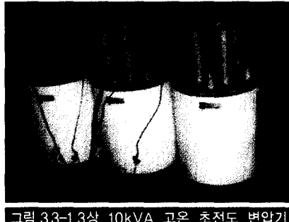
그림 3.3-1 3상 10kVA 고온 초전도 변압기 (2001, 기초전력공학공동연구소)
