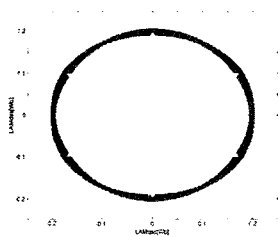
(d) 고정자 자속의 리사쥬 도형 (d) Lissajous figure for stator flux
