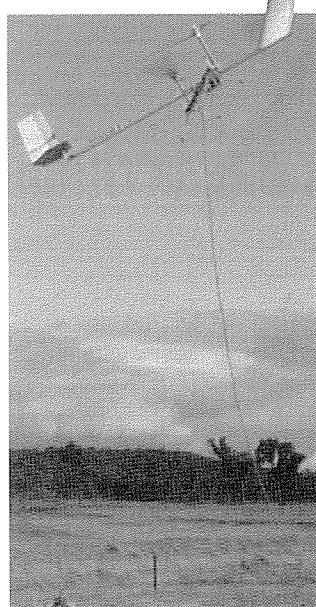
풍차는 큰 공간을 차지할 뿐더러 시끄럽고 미관에도 거슬린다. 그래서 호주의 웨스턴 시드니대학 과학자인 브라이언 로버츠는 다른 생각으로 이 문제에 접근했다. 그가 생각한 것은 자이로밀(gyromill)이라 불리는 공중의 풍차로서 이것은 천을 벗겨내고 헬리콥터의 회전날개를 단 거대한 연과 비슷하게 보이는 풍차이다. 이 자이로밀이 제트기류로 올라갈 때는 전기 모터가 회전날개를 돌린다. 일단 그 곳에 도착하면 모터는 꺼지고 제트기류가 날개를 돌려서 이 풍차가 공중에 떠있으면서 전기를 생산해 내게 한다. 전기는 동케이블로 지상에 송전된다. 로버츠는 각각 20메가와트의 전기를 생산하는 자이로밀의 함대를 꿈꾸고 있는데, 그는 50킬로와트급의 작은 시험용 자이로밀의 제작을 위해서 호주 정부에 1백만달러를 신청해 놓고 있다.
