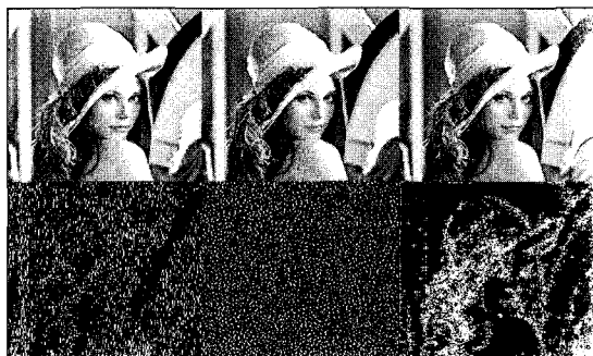
그림 7. 워터마킹 된 LENA 영상과 삽입된 워터마크 신호, 8x8 블록 기반 이산 여현 변환(좌), 이산 여현 변환(중), 웨이블릿 변환(우) Fig. 7. Watermarked image lena, and corresponding watermarks for 8x8 BDCT(left), FDCT (center), WT(right).
