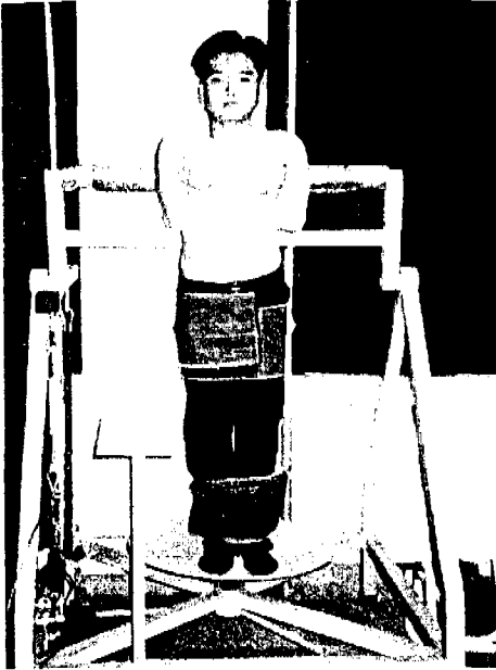
그림 1. ITEF (Isometric Trunk Exertion Frame)
