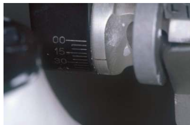
그림 2-5. 시상과로각사의 조절: 과두의 housing box를 모두 열어놓은 다음, bite가 가장 긴 밀한 상태에서의 housing 상대가 과두에 접촉하는 각을 계측한다.
