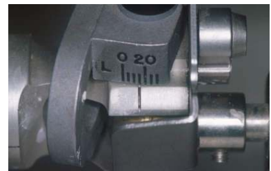
그림 2-6. 측방과로각사의 조절: 측방 check bite를 채득한 경우는 우측방 bite에 의한 좌측과로각을, 좌측방 bite에 의한 우측과로각을 조절한다. Hanau 교합기의 경우에는, 시상과로각을 계측하면 측방과로각은 공식을 이용해서 설정할 수도 있다.
