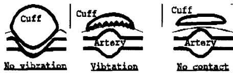
그림 1. 오실로메트릭 방법의 원리 Fig. 1. Principle of Oscillometric Method
