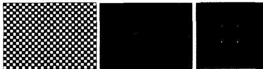
그림 2. \psi_a=0.478\pi 인 경우의 0-\pi 위상변조 특성. LCD 입력전압, 흑 = high상태, 백=low상태(왼쪽). CCD로 감지한 실제SLM의 영상(가운데). Fourier 면에서의 스펙트럼 세기 분포(오른쪽).
