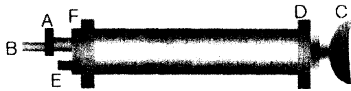
〈그림 1〉 검지관용 가스채취기 A. 검지관 절단기 B. 검지관 연결구 C. 피스톤 손잡이 D. 고정장치 E. 배기구 F. 흡입속도 조절구
