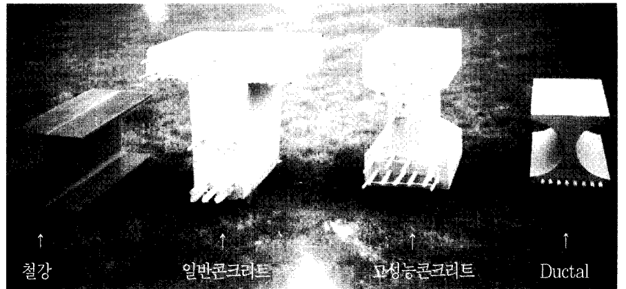
그림 3. 각각 다른 재료를 사용하여 같은 하중을 견딜 수 있도록 제작된 구조물의 크기 비교 <Lafarge 연구소 전시실>
