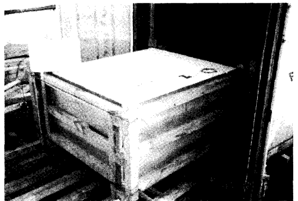
사진 3. Mat 기초 시험체 거푸집
