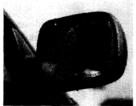
그림 4. 광촉매의 초친수성을 자동차 거울에 적용한 예
