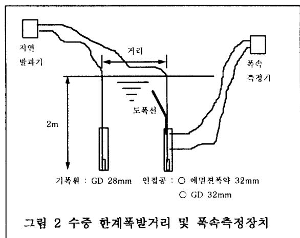
뇌관은 모두 순발로 역기폭을 하였고 자연발파기를 이용하여 자연시차를 임의로 조정하였다. 인접공의 뇌관은 충격압력에 의한 영향을 배제하기 위하여 보호관을 써웠다. 인접공 폭약의 폭속은 Instantel 사 VOD PROBE(Serial No. 0015)를 사용하여 측정하였다. 또한 인접공의 불폭여부를 판단하기 위한 방법으로 10g/m 도폭선을 사용하여 감지하였다..
