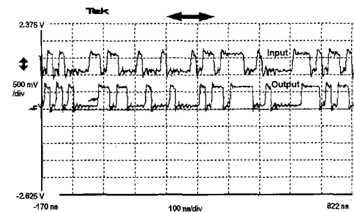
그림 10. 스위치 소자의 측정된 입출력 파형
