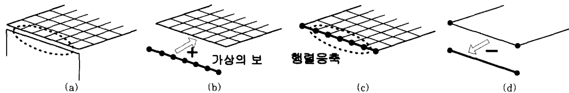
그림 17 가상의 보를 사용한 모형화 방법
