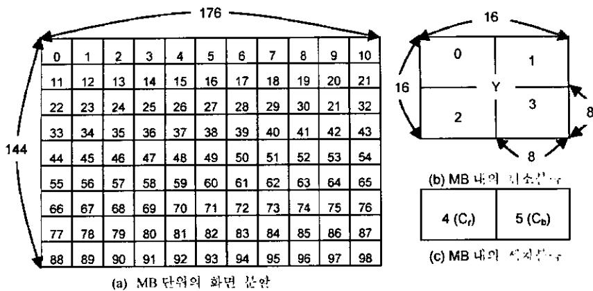
그림 2. 화면 분할 방법 및 MB의 구성: QCIF영상의 경우 화면 당 99개의 MB들, 각 MB별로 4 개의 흑도 블록 및 2개의 색차블록으로 구성
