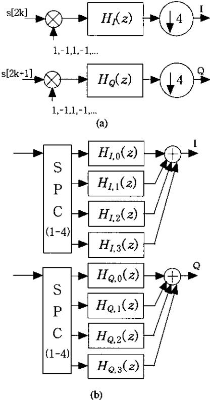
그림 7. (a) FIR DDC, (b) Polyphase로 (a)의 필터와 다운샘플러 구현(다운 샘플러는 SPC 안으로 위치 변경됨)
