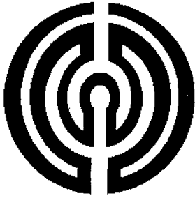
그림 1. 제작된 고온초전도 한류기의 설계 패턴.
