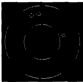
그림 4. 에지검출한후 세선화된 영상 Fig 4. The thinned image after edge detection
