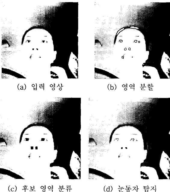
그림 7. 눈동자 탐지 과정. Fig. 7. Process for detecting a pair of pupils.
