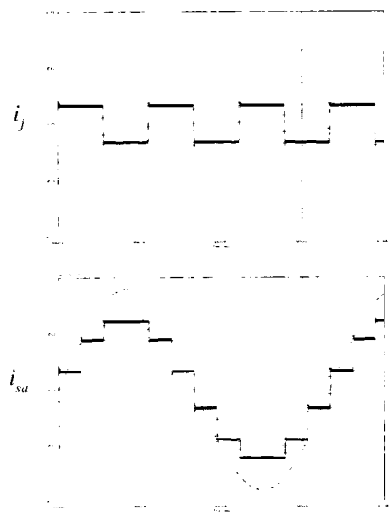
그림 4. 부하전류 재주입 방식의 12-펄스 정류기 10)
