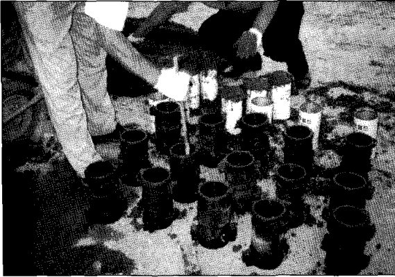
사진 2. 공시체 제작 및 모형시험
