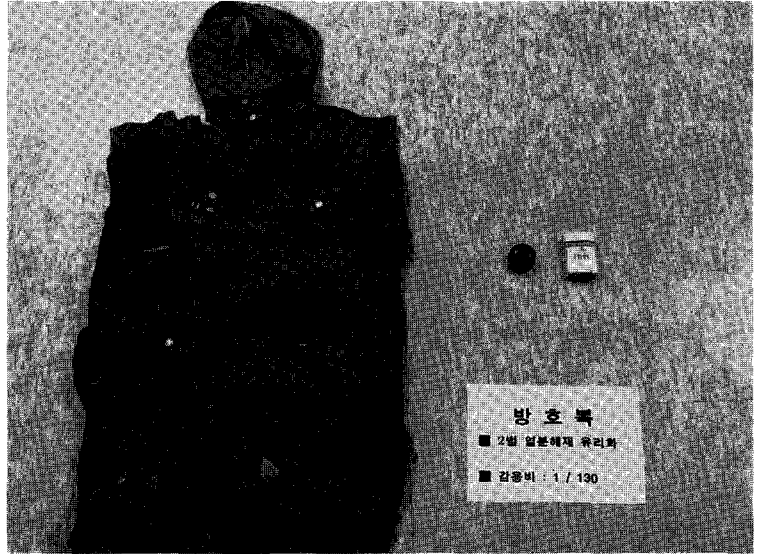
감용비 1/130로 유리화 처리된 방호복. 현재 전세계적인 유리화 연구 개발이 방사성 폐기물의 특정 형태, 즉 슬러리, 페이온 교환 수지 및 오염 토양 등에 치중해 있는 데 반해, 한전의 유리화 연구는 원전에서 발생하는 모든 방사성 폐기물을 처리할 수 있는 공정을 개발하는 데 있다.
